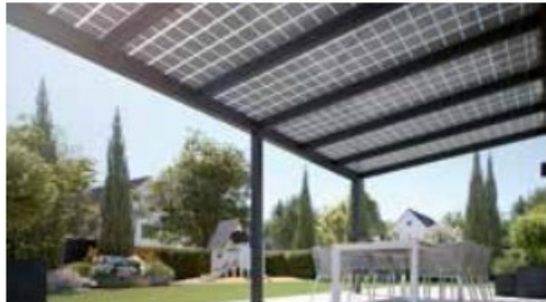
Abb. 18: Hier werden Glas-Glas-Solarmodule über einer Terrasse als Verschattung eingesetzt.
